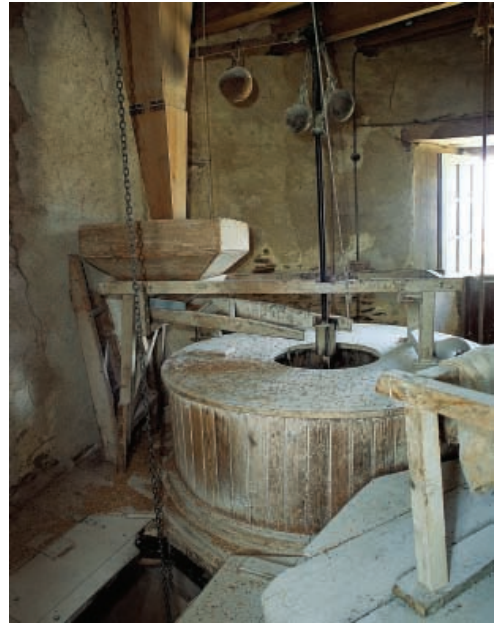
Au 2 e étage, la paire de meules à blé noir dans son coffrage, sa trémie et le régulateur de Watt qui contrôle l'écartement des meules.
