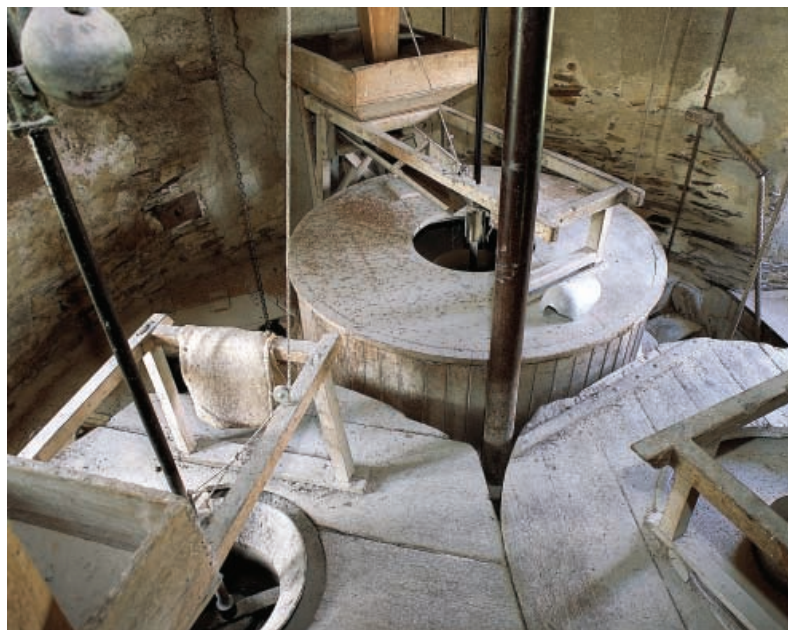
Au 2 e étage, les trois paires de meules dans leur coffrage avec une des trémies et au centre, le gros fer.
