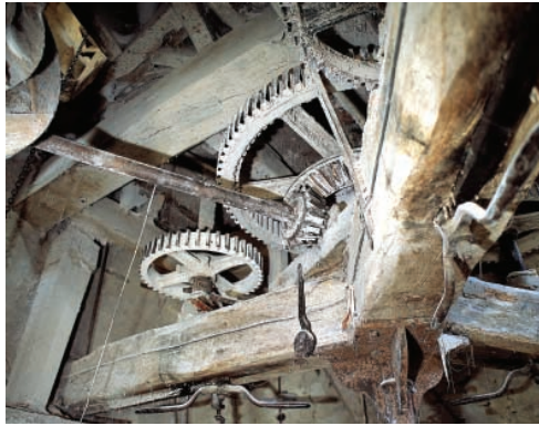
Au 1 er étage, la grande roue dentée, le « hérisson », distribue le mouvement aux couronnes entraînant les arbres verticaux des meules qui se trouvent au dessus.
